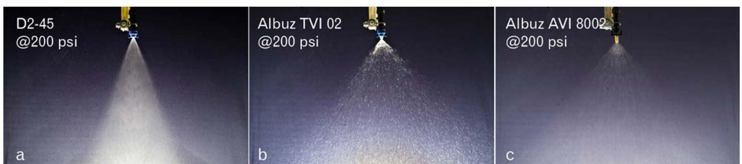
Figure 1. a) buse conventionnelle à jet conique (VF); b) buse à induction d'air à jet conique (VC-XC); c) buse à induction d'air à jet plat (M-C)
