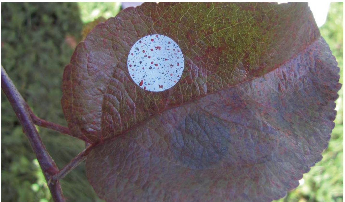
Figure 4. Couverture de feuillage produite par un pulvérisateur à jets portés utilisant des buses antidérive (pigments rouges) et des buses conventionnelles (pigments bleus).
