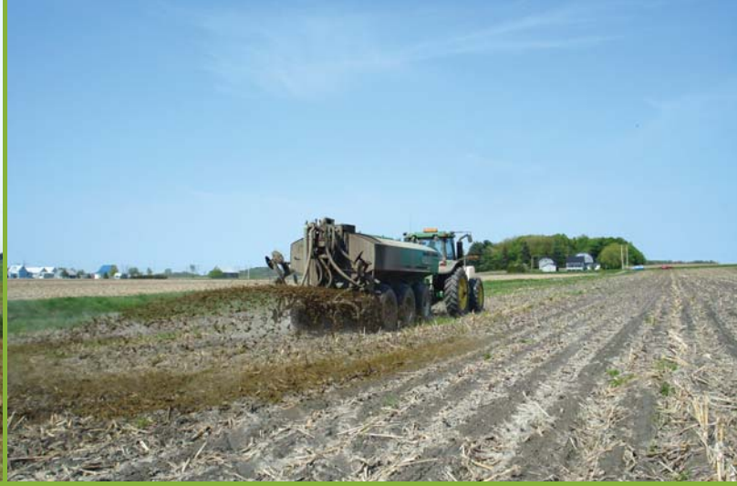
Figure 1 : Épandage par aéroaspersion basse de lisiers de bovins pailleux à contenu élevé en matière sèche.
