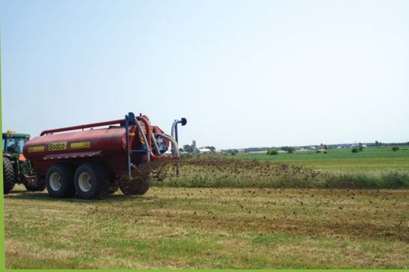
Figure 1 : Épandage par aéroaspersion basse de lisiers de bovins pailleux à contenu élevé en matière sèche.
