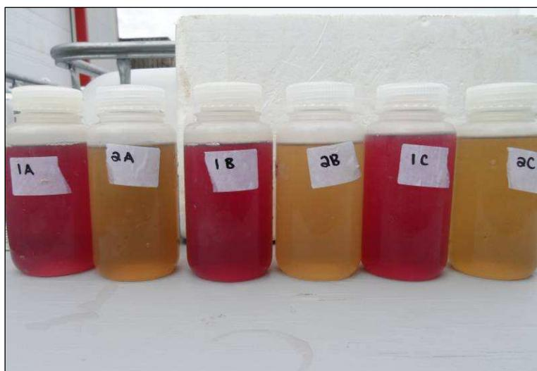
Figure 17. Échantillons prélevés 4 jours après le début de l'aération dans chacun des bassins lors de l'essai 2. Les échantillons 1(A,B,C) sont non aérés et 2(A,B,C) étaient aérés au taux de 0,02 Lair/Leau-min.
