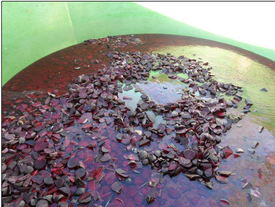
**Figure 20. Bassin de 300 litres d'eau contenant 69 kg de betteraves tranchées pour simuler l'eau de lavage de betteraves.**
