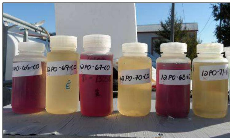
Figure 19. Échantillons prélevés 1 et 6 jours après le début de l'aération dans chacun des bassins lors de l'essai 2. À partir de la gauche, les échantillons sont en alternance non aérés et aérés. Le taux d'aération pour cet essai est de 0,01 Lair/Leau-min.
