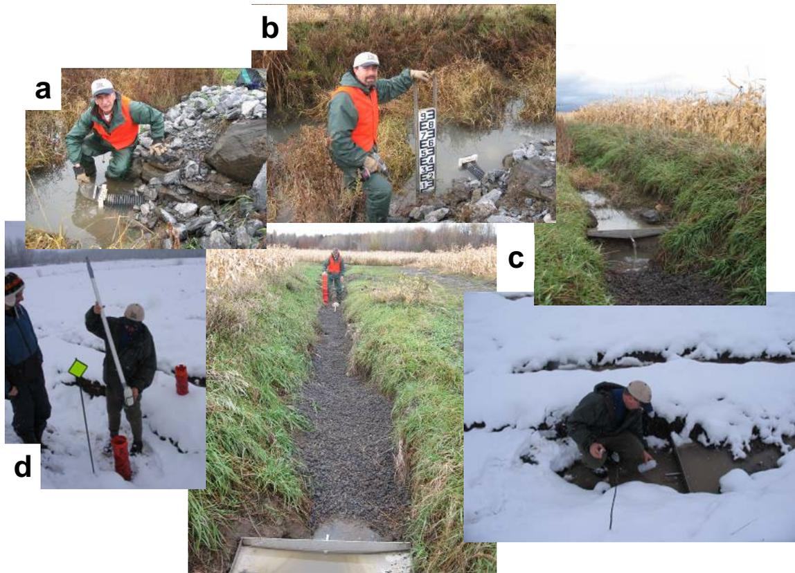
**Figure 5. Dispositifs de collectes et de mesures mis en place aux sites expérimentaux incluant la conduite d'évacuation munie d'un clapet anti-retour (a), l'échelle limnimétrique installée dans le ruisseau (b), le collecteur de ruissellement de surface (c) et le puits d'accès au lit de laitiers sidérurgiques (d).**
