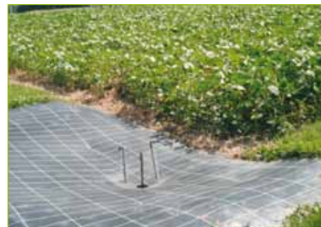
FIGURE 1 Dispositif de captage des eaux de ruissellement en aval d'une parcelle
