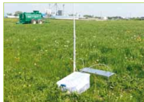
FIGURE 2 Chambre de volatilisation pour capter l'ammoniac
