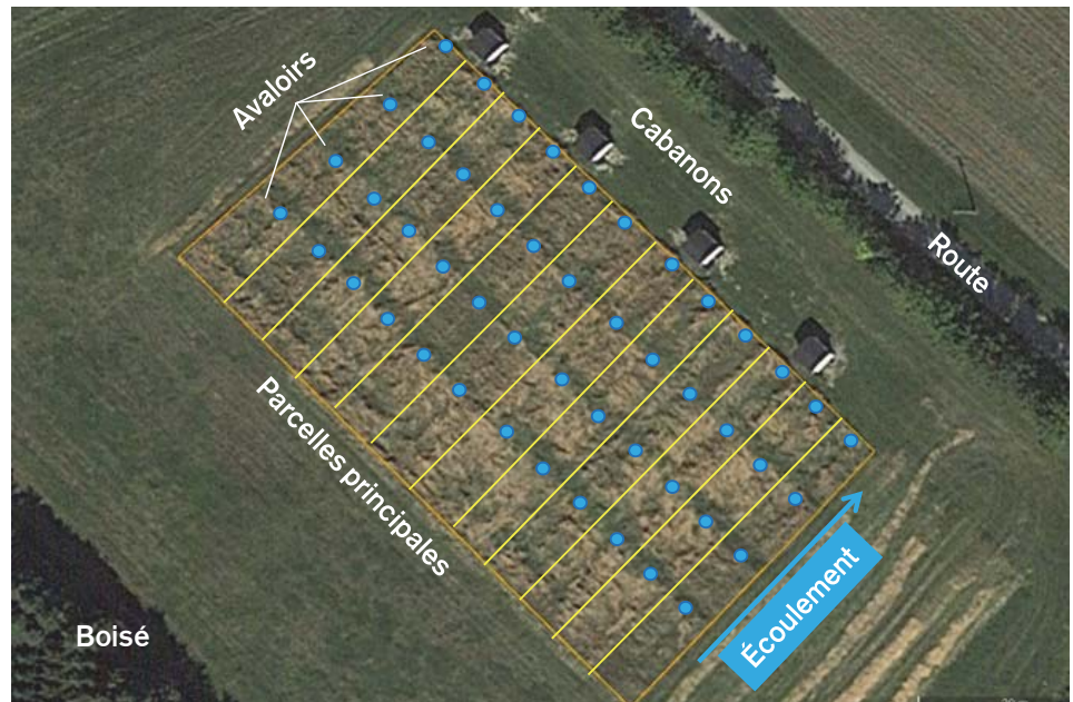
Figure 1 : Dispositif expérimental (vue en plan) comprenant 12 parcelles principales en tiroir
