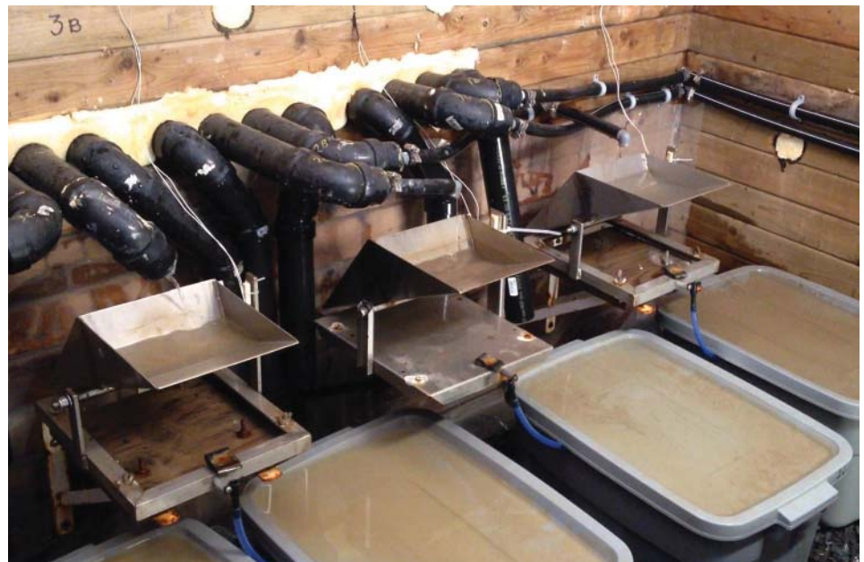
Figure 2 : Système de mesure de débit et d'échantillonnage de l'eau de drainage et ruissellement
