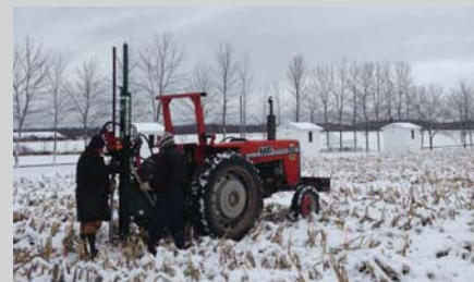
Figure 5 : Mesure des propriétés physiques du sol
