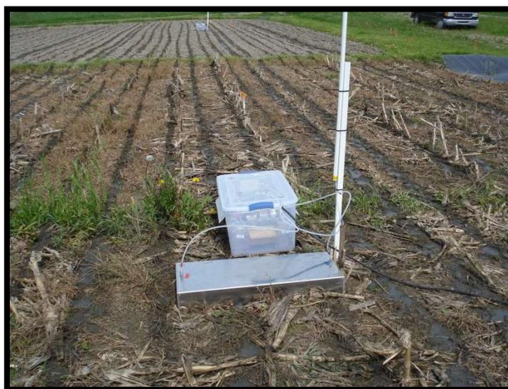
*Figure 3 Tunnel ventilé pour la collecte des émissions de NH<sub>3</sub> au champ*
