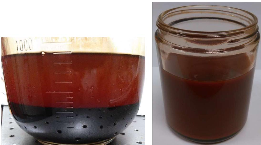
**Figure 9** Mélange huile - diesel après le traitement de brassage sans surfactant (gauche) et avec surfactant (droite)
