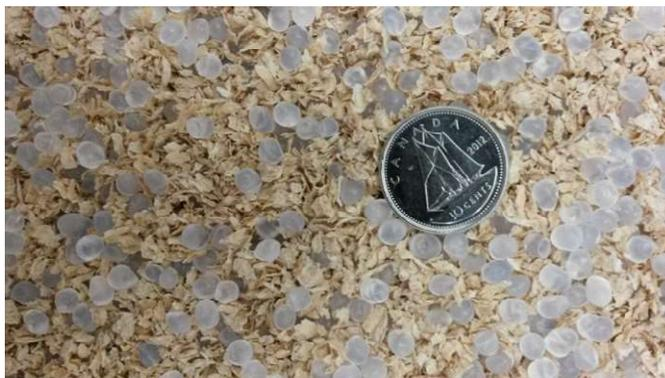
**Figure 2 Image du mélange bois-plastique utilisé pour l'étude de copyrolyse**
