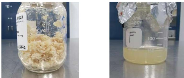
**Figure 5 Condensat obtenu par la pyrolyse du PEbd (gauche) et échantillon soluble dans le biodiesel (droite)**
