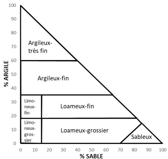
Figure 2 : Triangle des classes texturales de sols (à gauche) et des classes granulométriques de la famille de sols (à droite)
