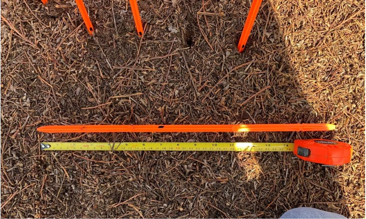
Figure 40. Profondeur de travail de la « Piqueuse » indiquée par une marque sur un piquet faite à la hauteur du sol une fois ce dernier enfoncé dans le trou.
