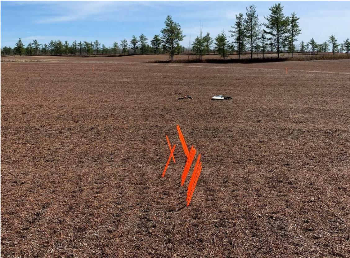
Figure 39. Angle de travail des tiges de la « Piqueuse » (deux passages en sens contraire) rendu visible en insérant des piquets dans les trous.
