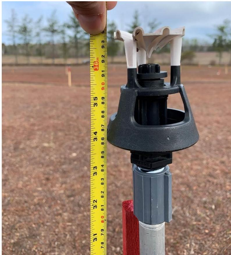
Figure 41. Tête d'un gicleur de marque Wobblers et hauteur de ce dernier par rapport au sol.
