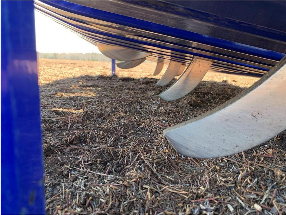
Figure 34. Vue du dessous de la « Trancheuse » en position levée.
