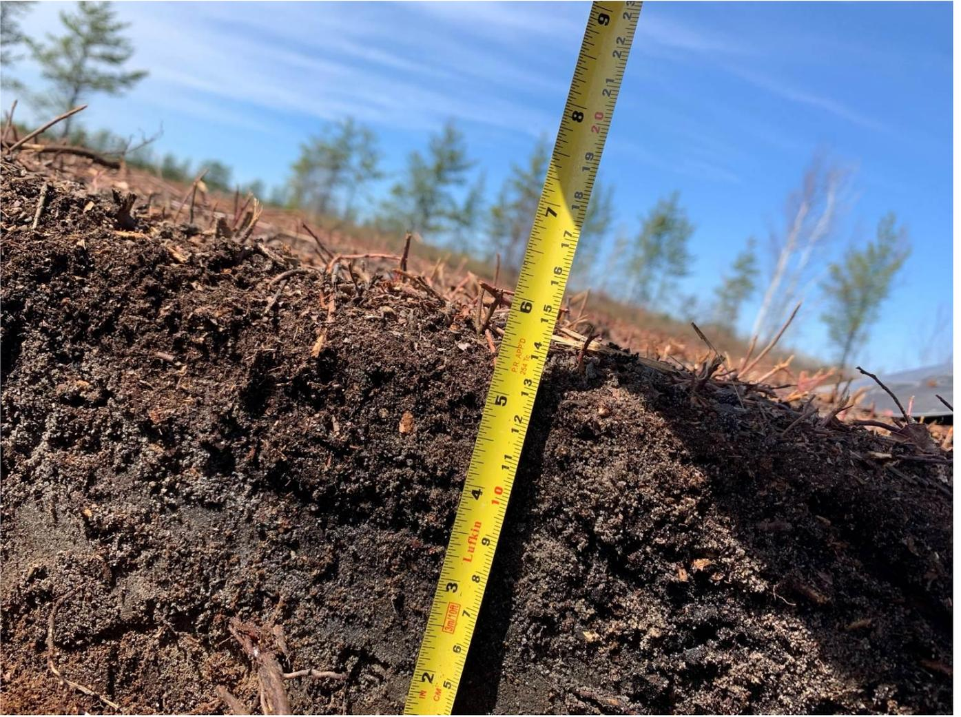
Figure 36. Profondeur de travail de la « Trancheuse ». Le sol a été dégagé entre deux passages de couteaux.
