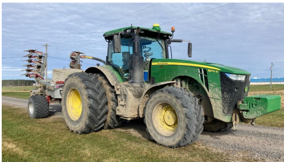
Figure 13. Tracteur et DM-AIR utilisés pour la compaction des sols dans les deux dispositifs expérimentaux.
